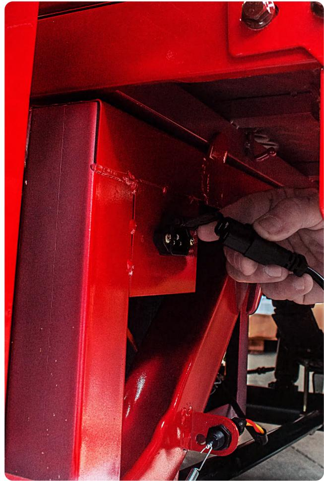
El King Kong se carga colocando el enchufe directamente en la entrada, ubicada en el lateral derecho del vehículo.
