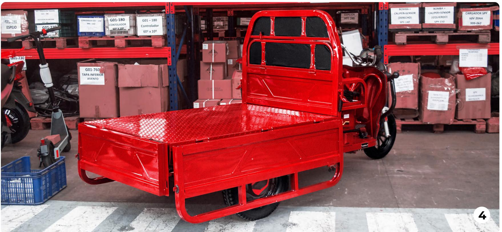
Para abrir las compuertas, quite las dos trabas de seguridad ubicadas en la parte frontal y lateral de la caja, y también las ubicadas en la parte posterior de la misma.
